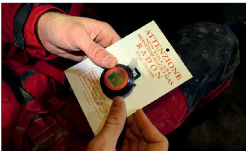
Progetto Radon - strumento per il monitoraggio del gas Radon
